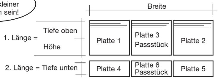
Die Montage des Thermo-Flex erfolgt hierbei in 2 Abschnittslängen.
