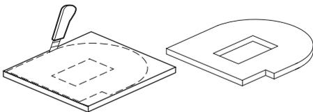
Zuerst werden die beiden seitlichen Dämmplatten ausgemessen, zugeschnitten und mit Schaum eingeklebt.
